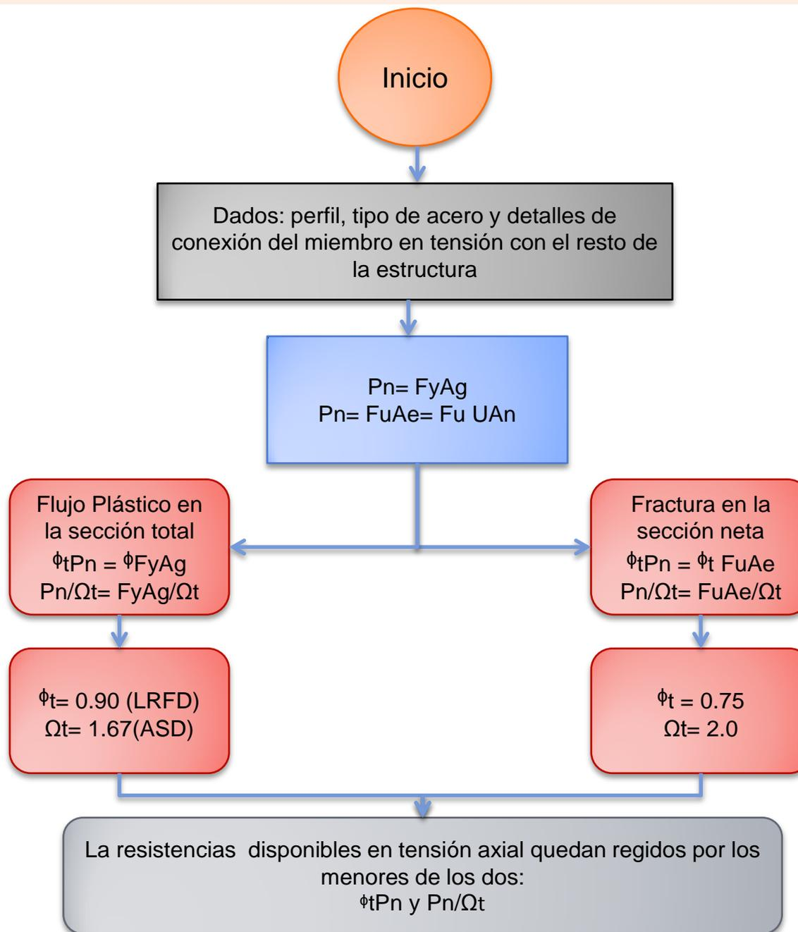
Véase la Sección D2. Resistencia en tensión, capítulo D Diseño de miembros en tensión. No se Incluye la revisión del estado límite de ruptura por cortante y tensión combinadas ("Block Shear rupture strength").
